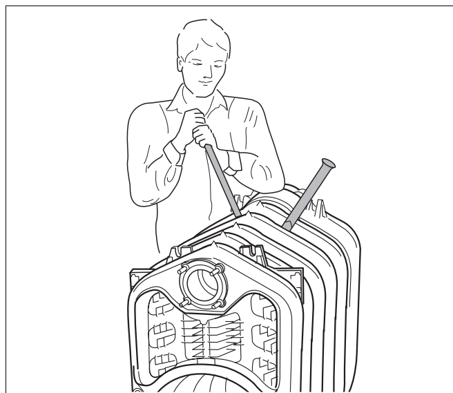
Рис. 27 Разъединение секций котла
